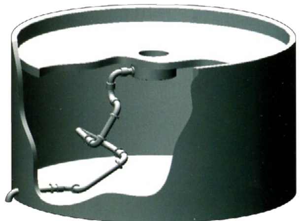
Drenážní systém pro plovoucí střechy uskladňovacích nádrží
